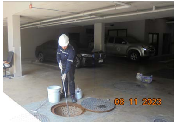
รูปที่ 3-4 การเก็บตัวอย่างคุณภาพน้ำทิ้ง บริเวณน้ำเสียก่อนเข้าระบบ (บ่อที่ 2)
