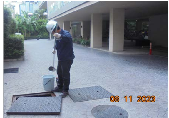
รูปที่ 3-6 การเก็บตัวอย่างคุณภาพน้ำทิ้ง บริเวณบ่อกักน้ำสุดท้ายก่อนระบายออกระบบ ระบายน้ำทิ้งสาธารณะ
