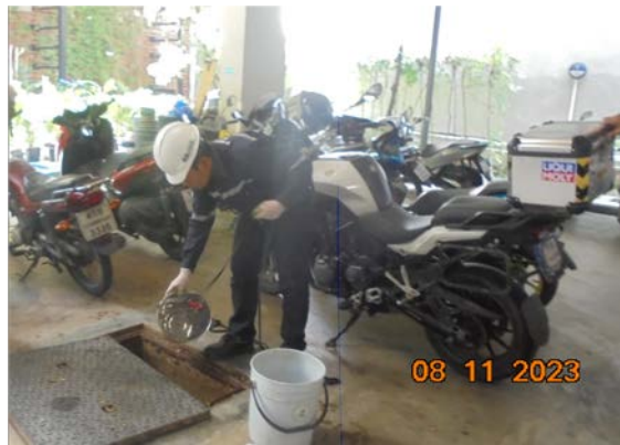
รูปที่ 3-5 การเก็บตัวอย่างคุณภาพน้ำทิ้ง บริเวณบ่อปรับสภาพ
